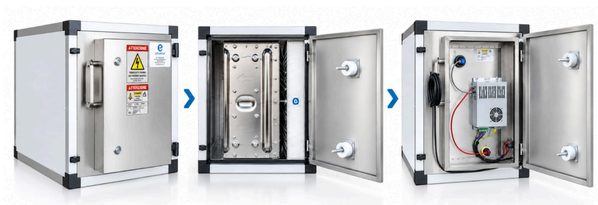
Sezione elettrostatica: sportello chiuso, cella in sede, alimentatore ad alta tensione all'interno dello sportello.
