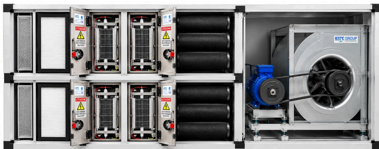
ARTURO con i portelli aperti, due stadi elettrostatici su due piani. Da sinistra: prefiltri G4, filtri F9, celle elettrostatiche, cartucce a carbone attivo e gruppo motore-ventilatore a trasmissione.
